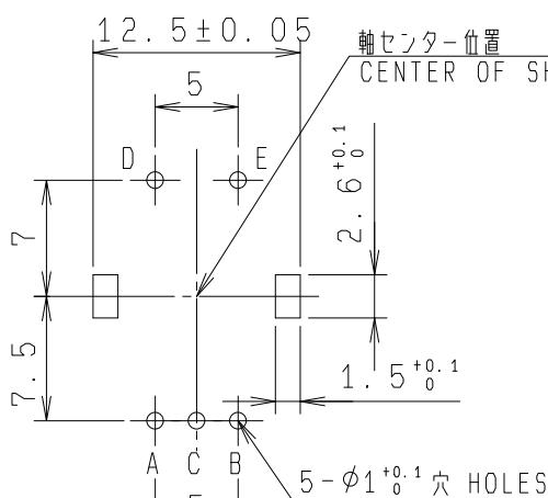
基板板厚  $t = 1.6\text{ mm}$
