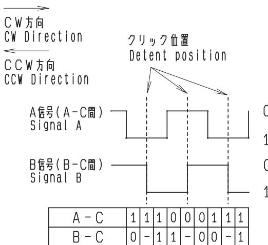
A - C 間の状態が変化した時にカウントし、CW, CCW の判定はその時の B - C 間の状態による。
