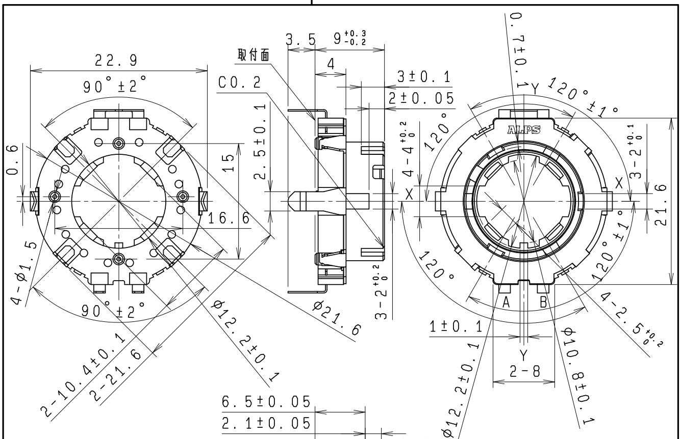
取付穴寸法図 許容差  $\pm 0.1$ あるいは $\pm 1^\circ$
