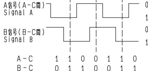
クリック位置より、A 信号が先に変化後、B 信号が変化した時に CW 方向と判定。
