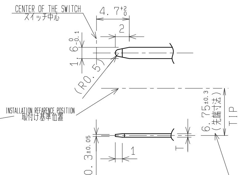
THE DIFFERENCE OF EACH CONNECTION TERMINAL SHALL BE MADE A RANGE IN THE ALLOWANCE.
